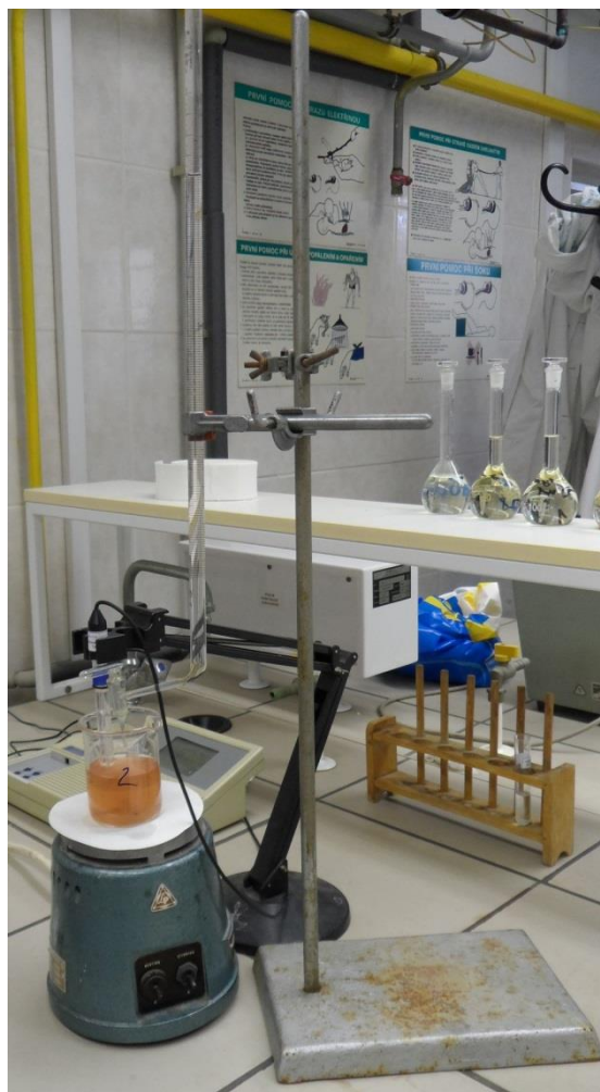
Obrázek 2: Názorná ukázka titrace (vlastní foto).
